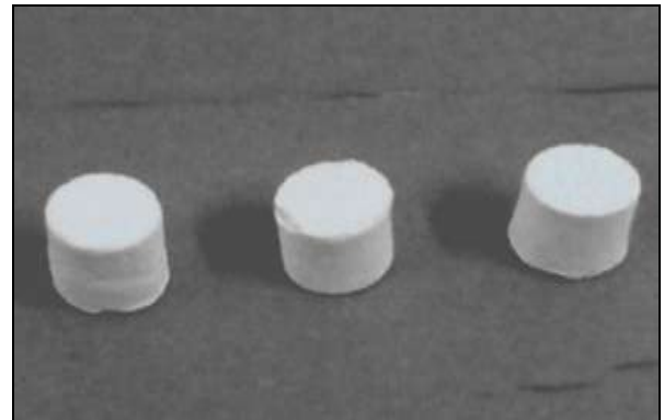
Fig. 5 Forme des éprouvettes mises en forme par coulage en barbotine.
