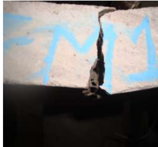
Figure 10 : Mode de rupture en flexion 4 points
