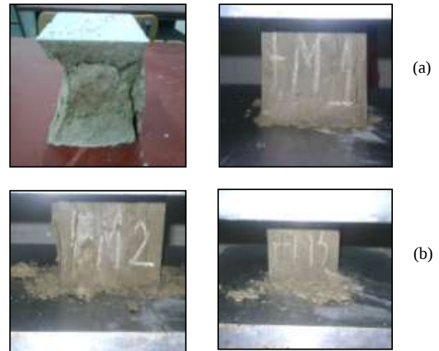
Figure 8 : Mode de rupture d'un BST et BSFM
