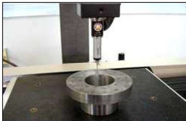
Fig. 4 –Contrôle de la planéité du palier sur MMT du Laboratoire de Métrologie (ENP d’Oran) [3]
