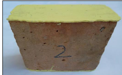
Fig. 10 : L'échantillon avec surfaçage
