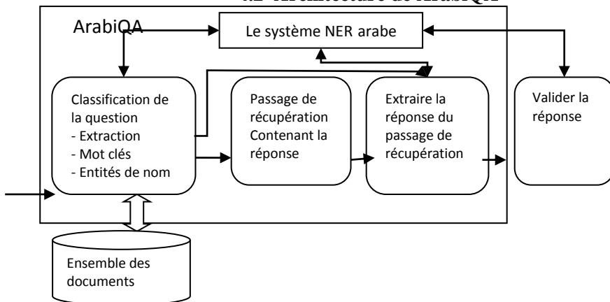
D'un point de vue général, le système se compose de composants suivants :
