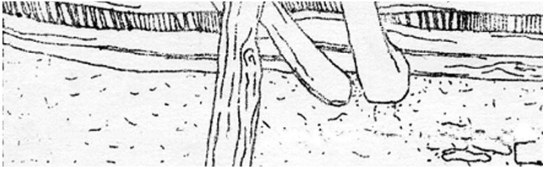
Fig. 33 : Support de plancher d'une chambre, à Roufi, dans les Aurès (J. Bachminski et D. Grandet, 1985, p. 7)
